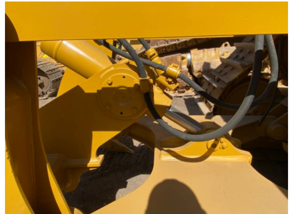
●●● Cilindro de levantamiento del desgarrador
